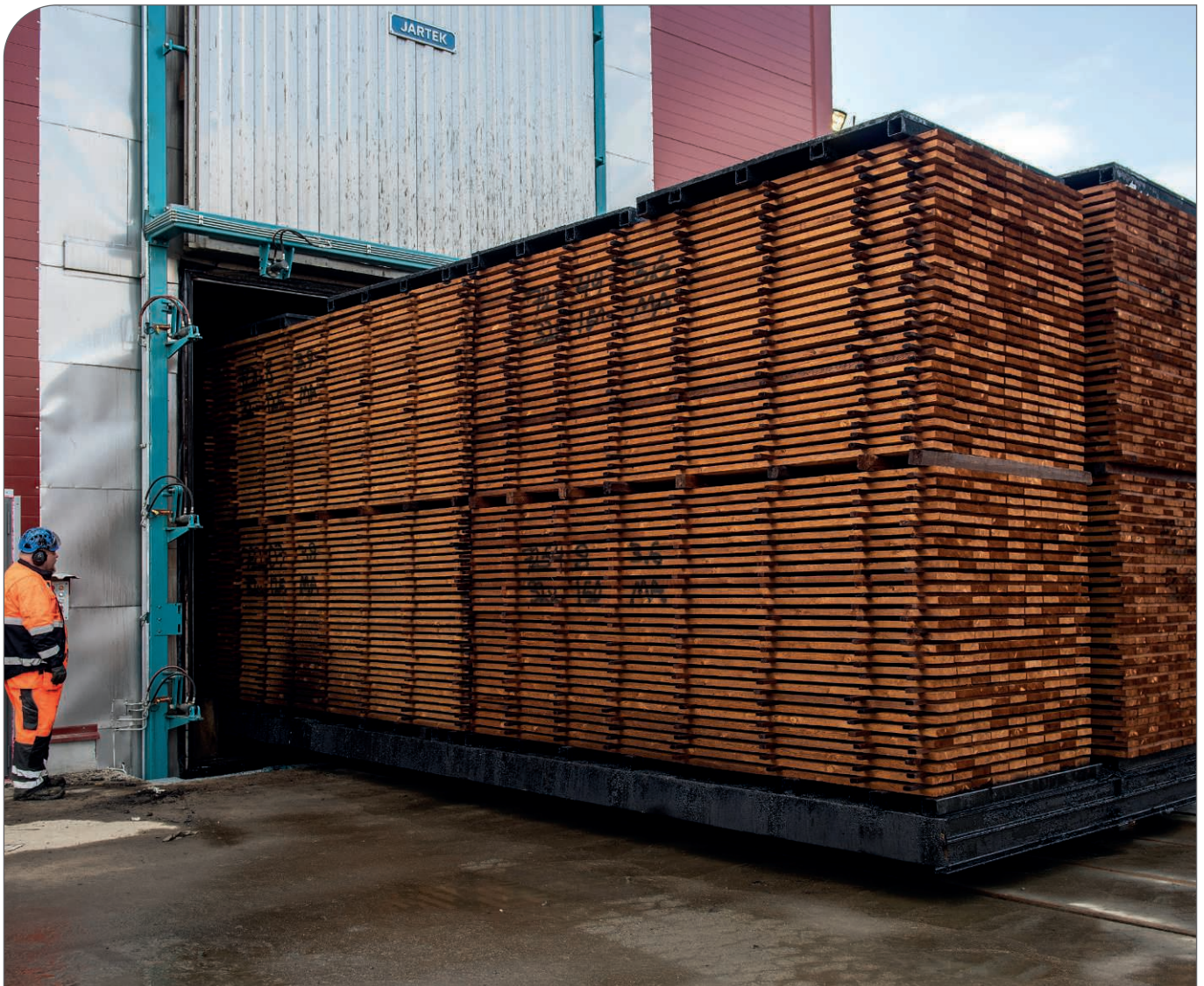
Kuva 4. ThermoWood®-lämpöpuuta valmistumassa prosessiunista.
