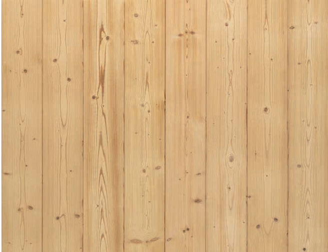
Kuva 8. Esimerkki pohjoismaisesta havupuusta valmistetusta lämpöpuutuotteesta (vas. Thermo-S, oik. Thermo-D).
