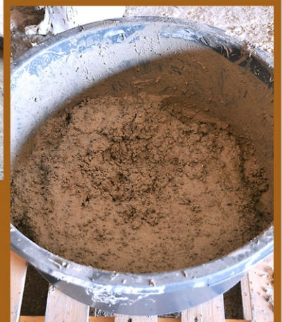
3. Pyyhe voi imeä laastin heti kokkareiseksi. Lisää vettä desi kerrallaan ja sekoita (alla).
