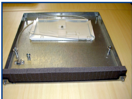
Kuidun liitosrasia aktiivilaitteen alla
