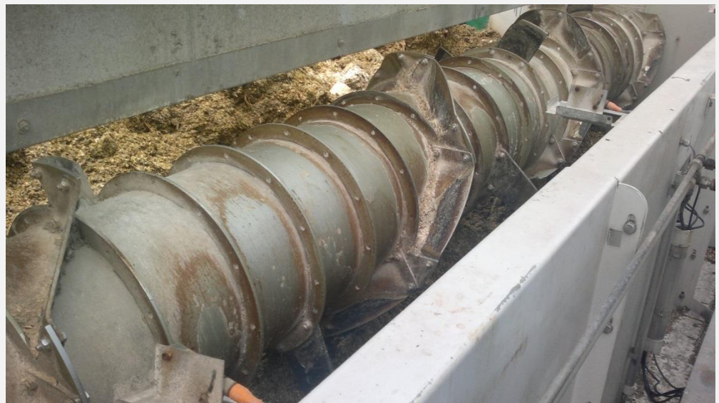
Kuva 2. Syötteen sekoitus ja hienontaminen ennen reaktoriin syöttämistä.
