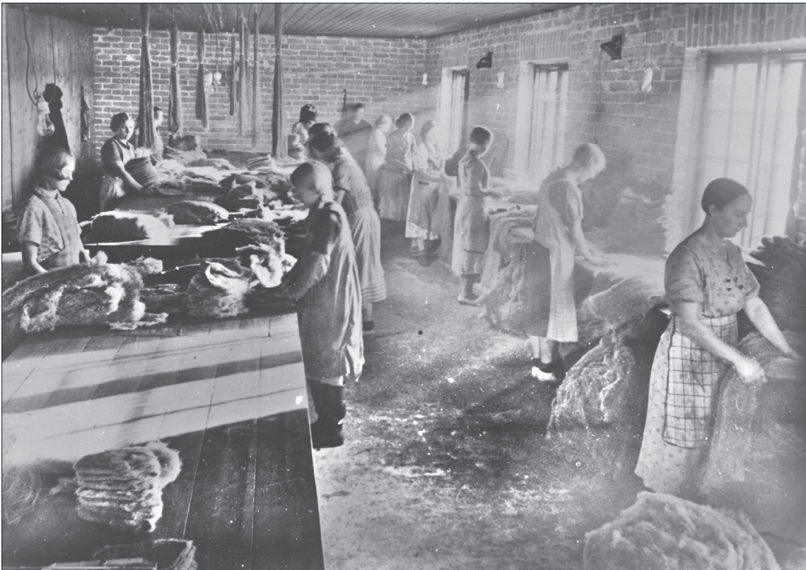
Huopatehtaan kokoomatilassa työskenteli kymmenkunta naista, jotka kokosivat levymäisistä villalepeistä huovikkaan puolikkaita.
