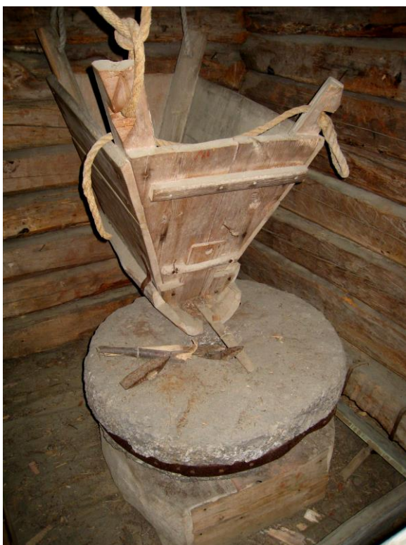
Ylinnä on kivipari M1. Alla vasemmalla tuntematon käytöstä poistettu kivipari M3, Oikealla kiviparin M2 alla konetasolla oleva siipikoneisto jauhojen puhdistusta varten.
