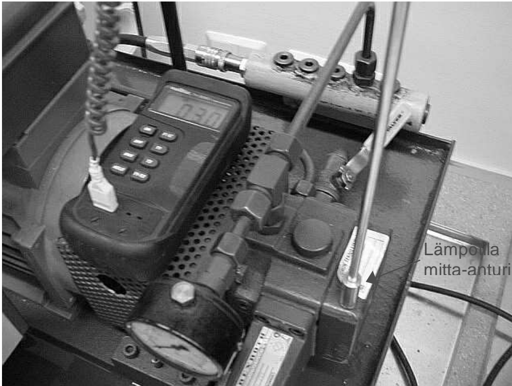
Kuvio 15 Lämpötilan mittaus digitaalimittarilla siipipumpun kotelosta
