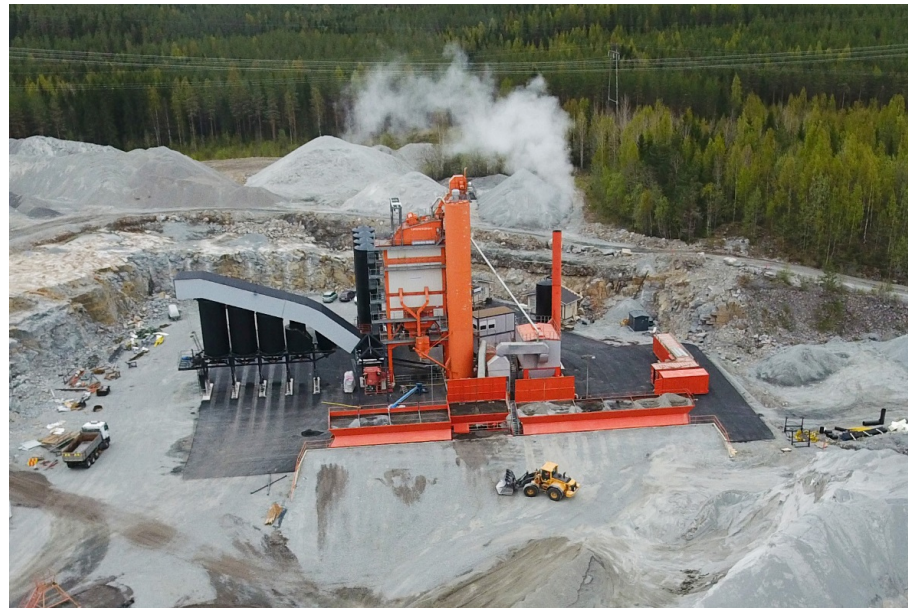
Jyväskylän asfalttiasema Benninghoven (BA4000), 2012, 240t/h
